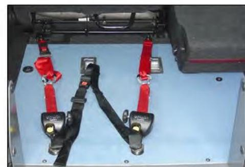
PAVIMENTO DI CALPESTIO IN ALLUMINIO CON RIVESTIMENTO IN PVC ANTISCIVOLO PERSONALIZZATO CON ATTACCHI CINTURE UNWIN.
