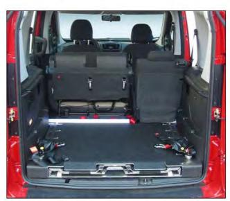
CON IL DISABILE A BORDO, IL VEICOLO MANTIENE L'UTILIZZO DI 3 POSTI A SEDERE PIU' LA PERSONA IN CARROZZINA IL CUI ACCESSO E POSIZIONAMENTO AVVIENE IN MODO SEMPLICE ED IN TUTTA SICUREZZA.
